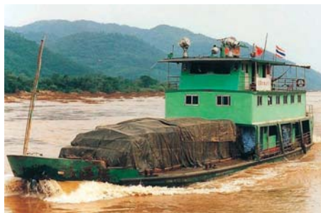
リンゴなどを満載してタイに向かう中国船。喫水線は浅い船体構造になっている。(2002年10月)
